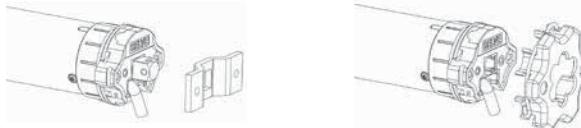
Oprócz tego można przykręcać różne kołnierze i płyty montażowe. Przy użyciu trzpienia, mocowanie musi być wyposażone w mechaniczny ogranicznik, zapobiegający przesunięciu trzpienia wzdłuż osi.
