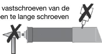
4. Plaats de wikkelbuis met zijn asprop en motor in de lagering en motorsteun. Knik motorkabel niet en verleg ze zodanig dat geen beschadigingen kunnen ontstaan. Verleg hem met een kleine lus naar beneden zodanig er geen water in de motor kan druipen.
