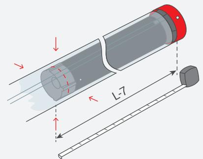
6. Fissare il tubo di avvolgimento all'involucro, utilizzando quattro viti o rivetti, collocati a una distanza  $L-7$  mm dal bordo interno della testata.
