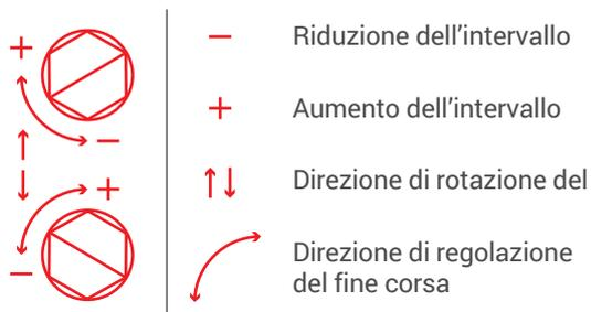
Per impostare la posizione finale superiore o inferiore, avviare l'avvolgibile nella direzione di apertura o di chiusura, finché la tapparella non si fermerà nella posizione preimpostata. Per aumentare l'intervallo, ruotare la manopola in direzione "+". In presenza di un intervallo eccessivo, ridurlo effettuando una rotazione in direzione "-".
