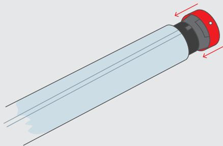
5. Inserire il dispositivo di movimentazione nel tubo di avvolgimento, in modo tale che il bordo del tubo aderisca al bordo interno della testata.
