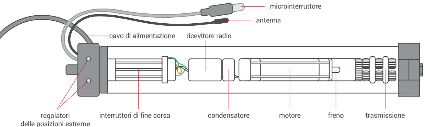
Il tempo di funzionamento massimo del dispositivo è pari a circa 4 minuti. Al superamento di questo periodo, entrerà in funzione il meccanismo di sicurezza termico, che disattiverà il motore per proteggerlo dal surriscaldamento. Dopo che l'interruttore termico sarà entrato in funzione, attendere 20 minuti, affinché il dispositivo possa essere riutilizzato.
