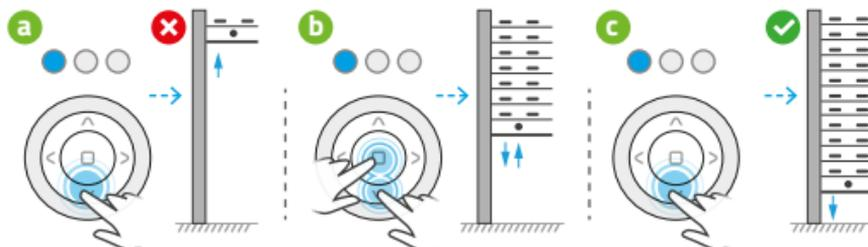
**ATTENTION!** L'opération de modification de direction du servomoteur MOBILUS avec bornes électroniques ne peut être effectuée qu'après avoir réglé les extrémités supérieure et inférieure. Pour les servomoteurs MOBILUS avec limiteurs mécaniques, le changement de direction peut être effectué à tout moment.
