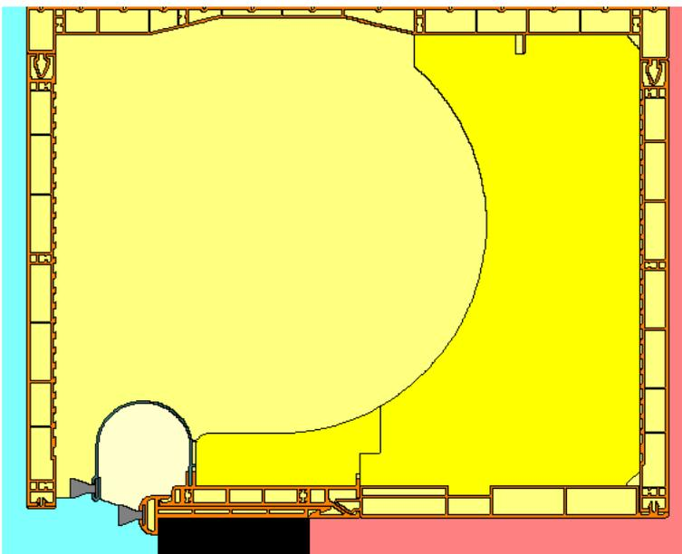
**Bild 2** Simulationsmodell zur Berechnung des Wärmedurchgangskoeffizienten (Berechnung mit einer Bautiefe des Blendrahmens: Adibat 60 mm)
