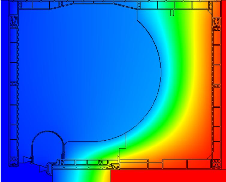
**Bild 3** Simulationsmodell (Temperaturfelder) zur Berechnung des Temperaturfaktors (Berechnung mit einer Bautiefe des Blendrahmens: Weichholz 70 mm)
